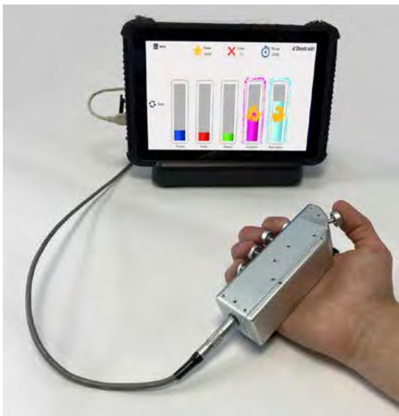
*Exercice permettant d'entraîner l'individualisation des mouvements des doigts. La force exercée par chacun des doigts est représentée par une jauge de force (une colonne). Une cible visuelle apparaît et indique le ou les doigts à activer par le patient. Il doit alors remplir les jauges correspondant aux doigts ciblés. © Dextrain*
